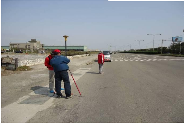
圖 3-3 臺中港進行管線孔蓋測量情況 (透空良好)
