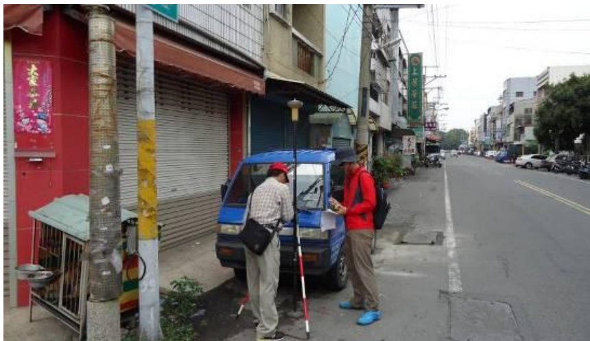
圖 3-23 雲林虎尾市區 e-GNSS 系統進行管線孔蓋測量情況
