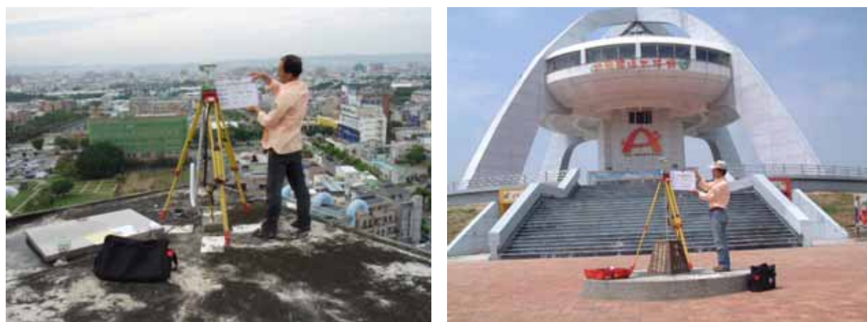
圖 4-3 e-GPS 外業測量情形
